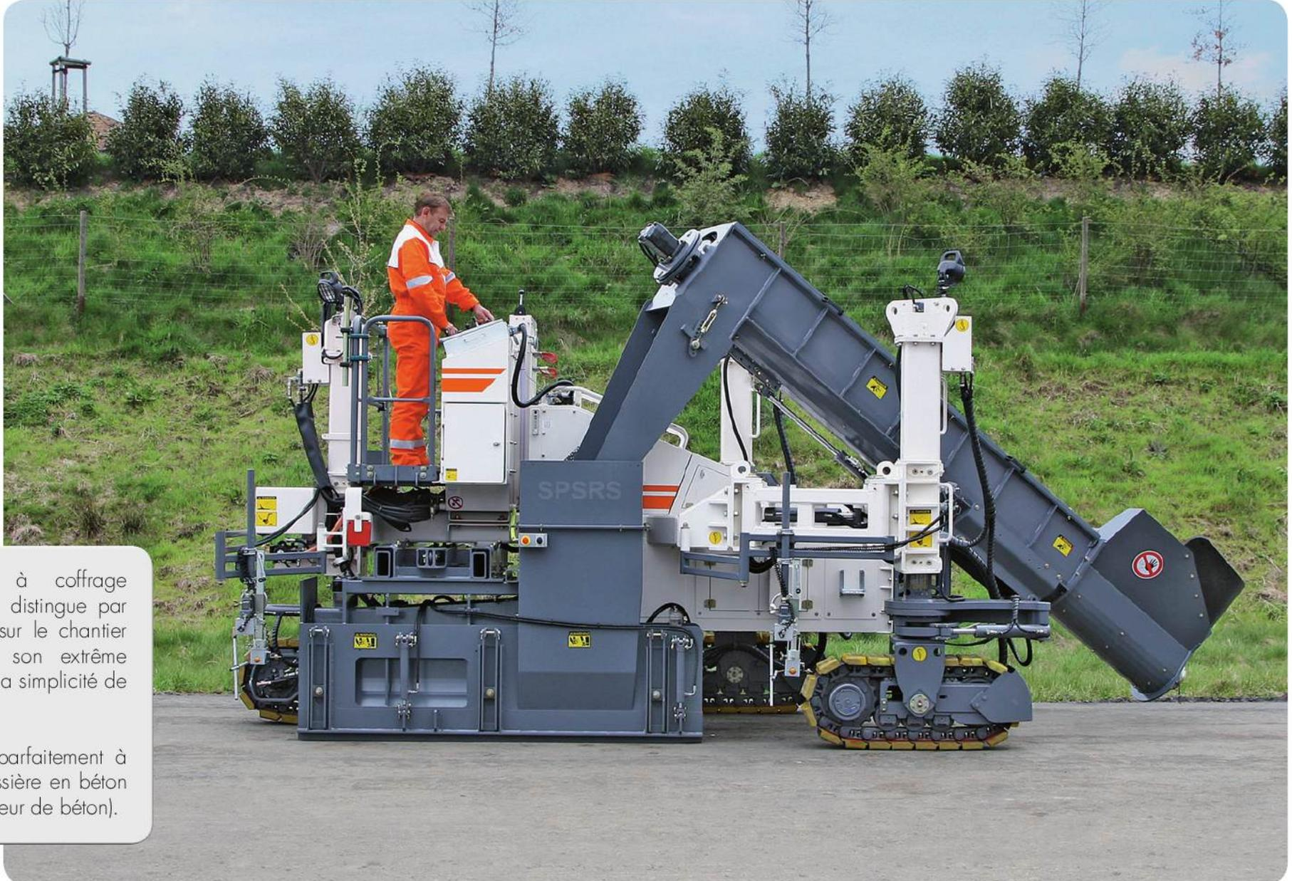
La machine à coffrage glissant qui se distingue par sa robustesse sur le chantier au quotidien, son extrême maniabilité et sa simplicité de commande.
